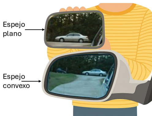
Fig. 6-P8. Los lentes convexos se aplicaciones en retrovisores, el conductor obtiene información visual de un área mucho mayor.
